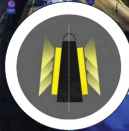
Chip led posizionati con angolo diedro per una migliore emissione luminosa
